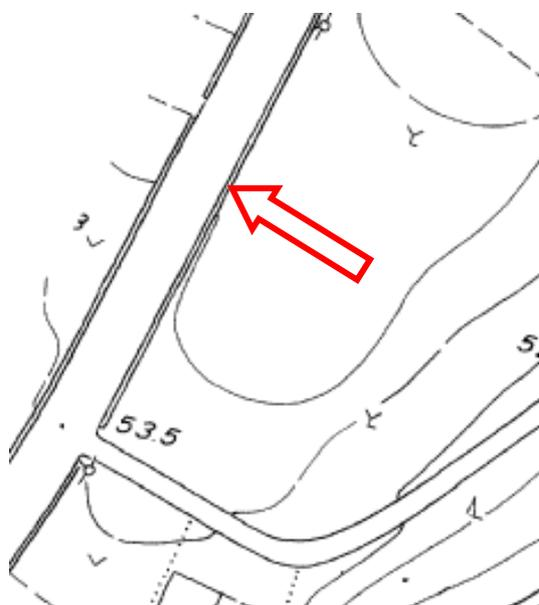
擁壁など上端線と下端線が図上で重複する場合は、両線とも取得し上端線データを S-BLINE に、下端線データを S-BLINE-SUB に格納する。
