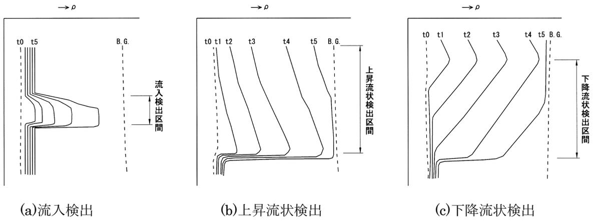
図 2-5 地下水検層結果の判定例
