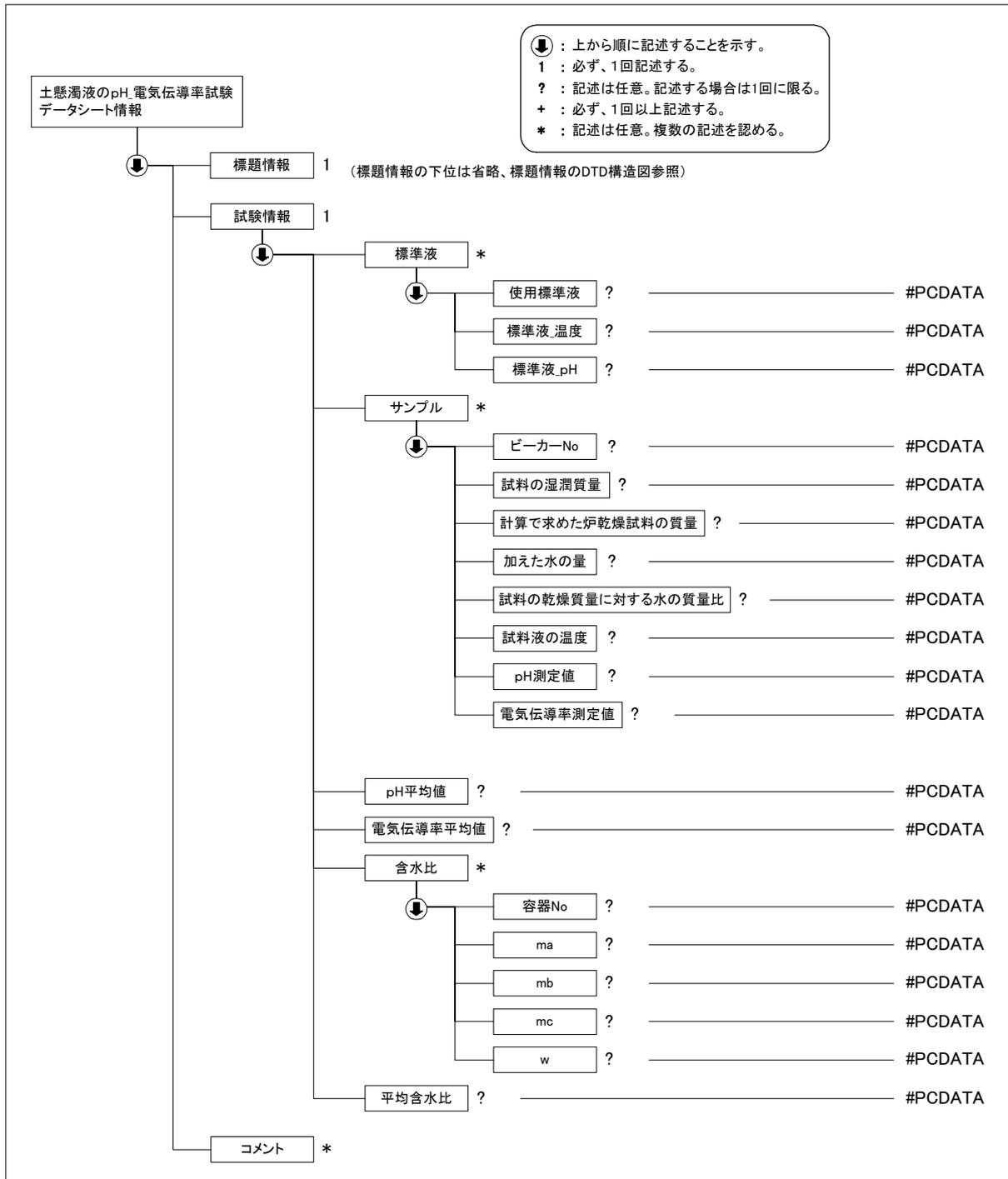
(3) 土懸濁液の pH 試験、土懸濁液の電気伝導率試験データ(B0211\_02.DTD)の定義内容
