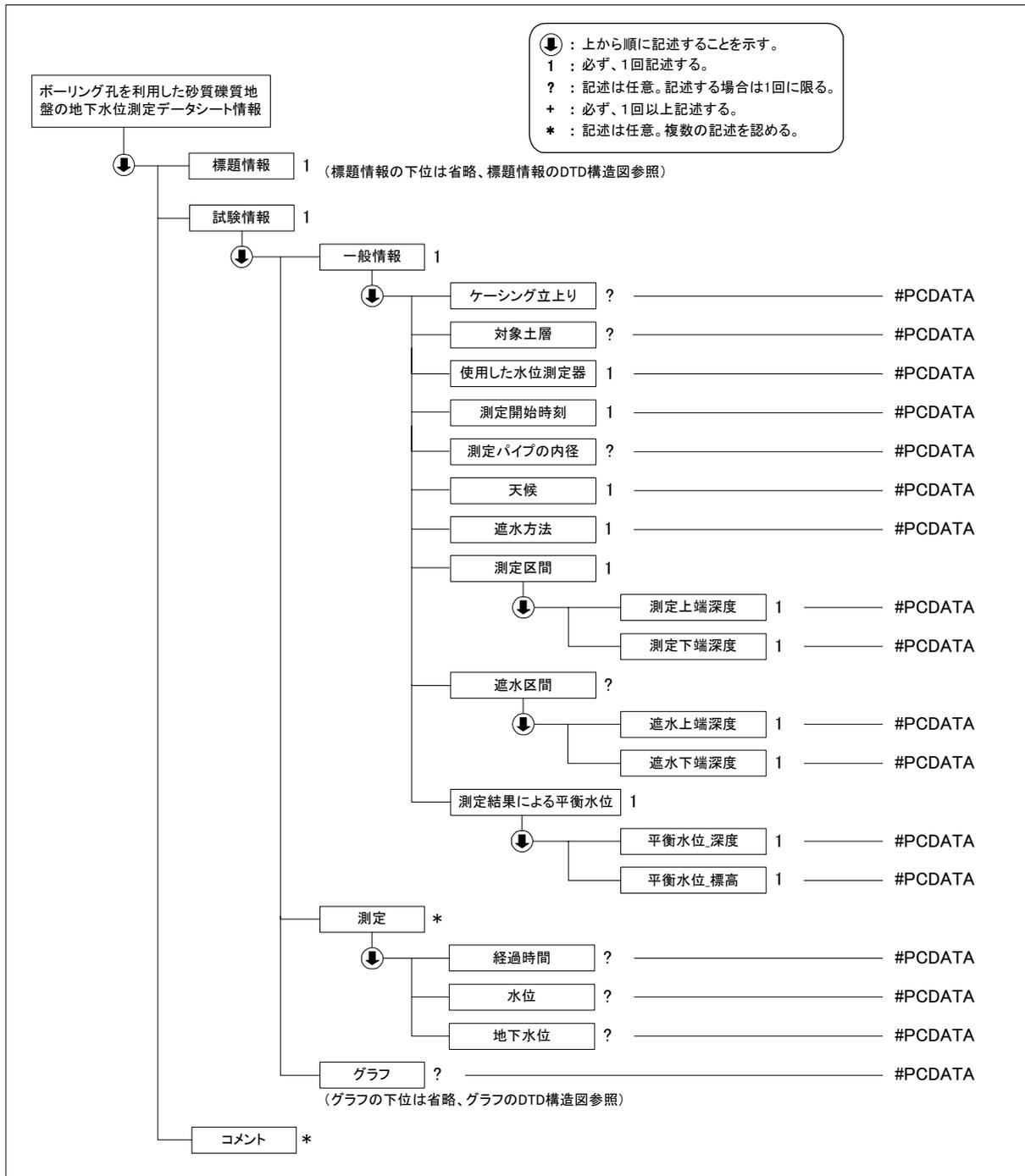
(3) ボーリング孔を利用した砂質・礫質地盤の地下水位測定データ(B1311\_02.DTD)の定義内容
